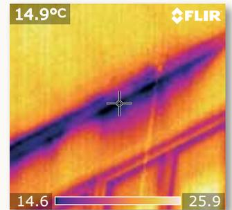
Das Infrarotbild zeigt einen schlecht gedämmten Dachanschluss, durch den kalte Luft eindringt.
