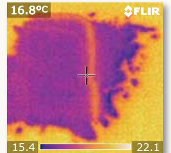
Mit Hilfe der Thermografiekamera wird Feuchtigkeit im Boden sofort nachgewiesen. Mit dem bloßen Auge ist dies nicht erkennbar.
