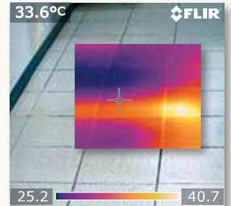
Dank der Bild-in-Bild-Funktion können versteckte Problembereiche sofort eingegrenzt werden. Temperaturmessungen werden punktgenau durchgeführt.
