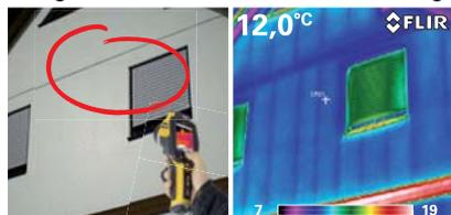
Eine fehlende Dämmung wird in der Wand erkannt. Zusätzlich wird die Ständerkonstruktion sichtbar.
