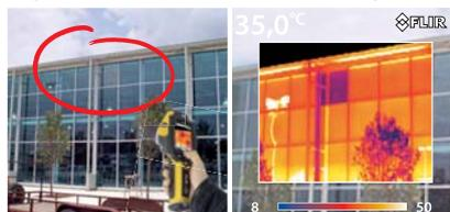
Die Thermografieinspektion deckt ein falsch eingebautes Fenster auf.
