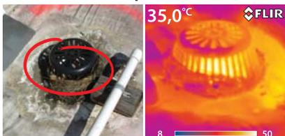
Das Wärmebild zeigt Wasserlecks im Flachdach.
