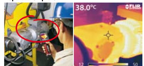
Mechanische Überprüfung eines Elektromotors mithilfe der FLIR i60.
