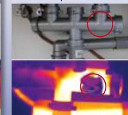
Le blocage de cette canalisation est rapidement localisé au moyen d'une caméra thermique. Il faut agir avant que la situation s'aggrave.
