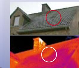
L'inspection par infrarouge permet de voir un défaut d'isolation du toit. Il va maintenant pouvoir être réparé pour éviter toute fuite d'énergie supplémentaire.
