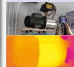
L'inspection de cette pompe à eau permet de constater qu'il n'y a aucun problème. L'image infrarouge prouve la présence d'eau dans le cylindre. Aucun danger de surchauffe.
