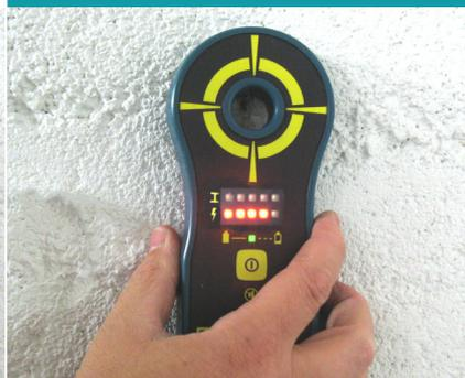
...oder Metalle, wie Betonstahl, Rohre oder Kanäle
