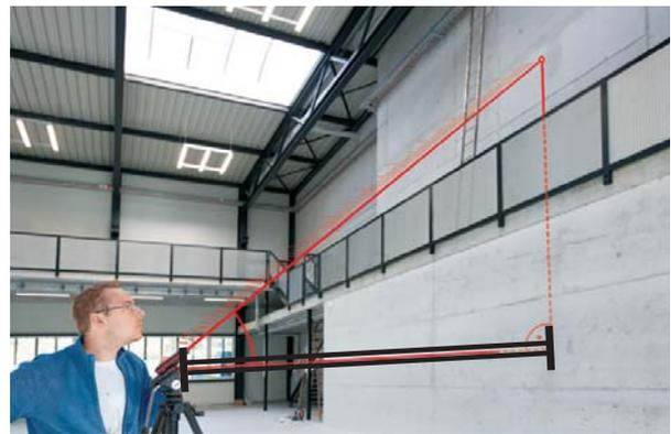
Indirekte Höhenmessung mittels
