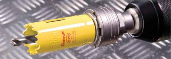
ULTI-MATE von Starrett ermöglicht den schnellen, werkzeuglosen Wechsel von Lochsägen unterschiedlicher Durchmesser ohne das Bohrfutter zu lösen. Durch entfernen der Lochsäge von der Aufnahme wird der Sägekern ausgeworfen.
